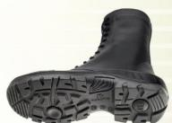
Solado Constituído de duas camadas de poliuretano (PU), injetado diretamente no cabedal, sendo a 1ª camada (entressola) mais macia e leve, com densidade de 0,4g/cm³ proporcionando maior conforto; e 2ª camada (sola) mais compacta com densidade de 1,0 g/cm³, resistente a objetos cortantes, perfurantes e a abrasão com sistema antiderrapante constituído de ranhuras especiais de 3mm de altura e 6mm de largura e resistencia ao escorregamento em piso cerâmico e piso de aço (Nível SRC).
